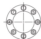
図2 クランプねじ締付け順序
