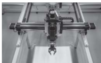
直交ロボット 長尺往復機構のコンパクト設計に X・Y・Z 軸の駆動機構
